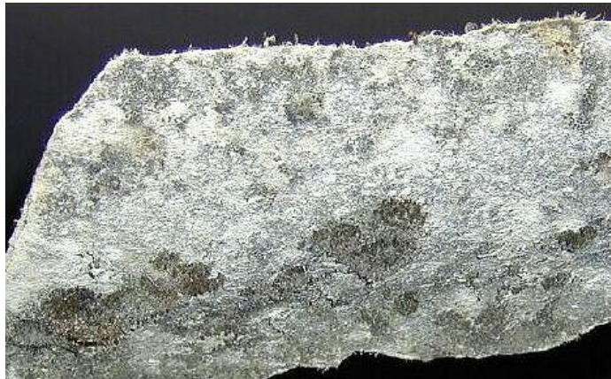
Figuur 3: breukvlak met asbestvezels
