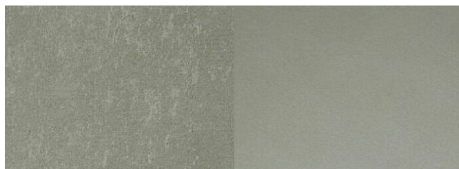
Figuur 9: asbesthoudende (links) en asbestvrije plaat
